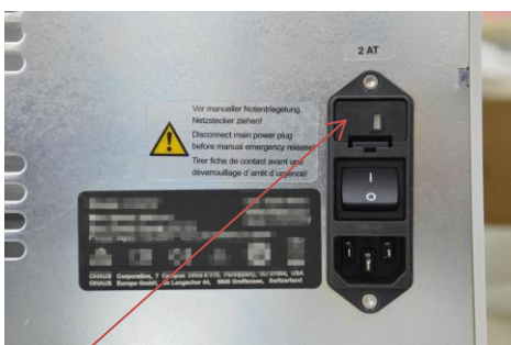
Sicherungsschublade mit Sicherung 4 AT
